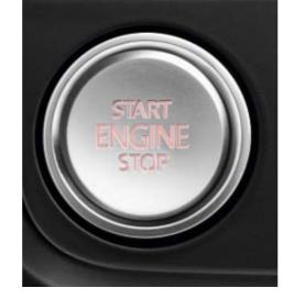
Für höchsten Komfort steht das schlüssellose Schließ- und Startsystem "Keyless Access". Eine ausgeklügelte Funk- und Sicherheitstechnik ermöglicht das Öffnen und Schließen ohne aktive Nutzung des Schlüssels. Das Starten und Abstellen des Motors erfolgt per Knopfdruck. |so
