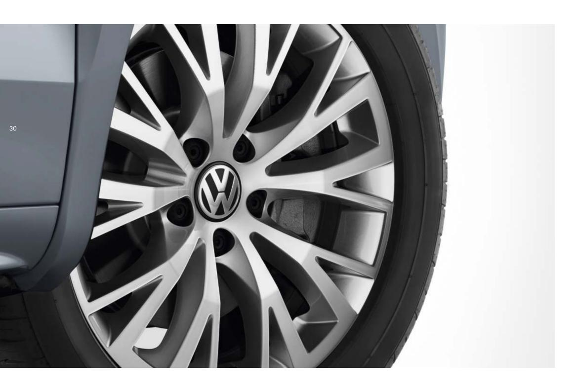
← Das 17-Zoll-Leichtmetallrad "Jarama" mit Bereifung 225/50 R 17 zeigt sich mit glanzgedrehter Oberfläche außergewöhnlich und dynamisch zugleich. |so
