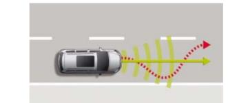
Der Spurhalteassistent "Lane Assist" lenkt die Aufmerksamkeit des Fahrers mit einem korrigierenden Lenkeingriff wieder auf das Fahrgeschehen, wenn das Fahrzeug droht, unbeabsichtigt die Spur zu verlassen. | so
