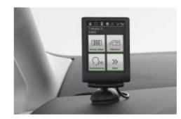
Die benutzerfreundliche Bluetooth-Freisprecheinrichtung "Touch Phone-Kit" hat ein TFT-Farbdisplay mit Touchscreen und garantiert den neuesten Stand der Technik sowie ein Höchstmaß an Bedienkomfort. Eine sichere Handhabung des Geräts während der Fahrt ist dank der Sprachsteuerung kein Problem. Sogar Textnachrichten werden von der Anlage klar und verständlich vorgelesen. so
