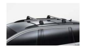
Die stabilen **Tragstäbe** sind die Systembasis für alle Aufbauten und lassen sich leicht und vor allem schnell an der Dachreling anbringen. Dank der diebstahlhemmenden Verschlusseinrichtung sind Sie vor bösen Überraschungen geschützt.
