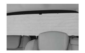
Vor übermäßiger Erwärmung des Innenraums und direkter Sonneneinstrahlung im hinteren Bereich schützt der Sonnenschutz für die hinteren Seitenfenster, Kofferraumscheiben und die Heckscheibe. Und das, ohne die Sicht nach hinten und damit die Verkehrssicherheit zu beeinträchtigen. so
