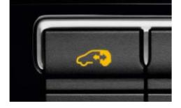
Als äußerst komfortabel erweisen sich die elektrischen Schiebetüren, die per Knopfdruck bequem aus dem Innenraum geöffnet werden können. |so
