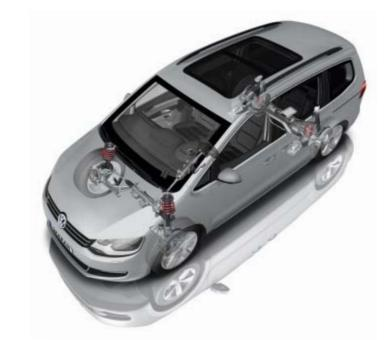
← Die adaptive Fahrwerksregelung DCC stellt innerhalb von Millisekunden jeden Dämpfer individuell auf die Fahrbahn und die Fahrsituation ein. Per Knopfdruck haben Sie dabei die Wahl zwischen den drei Varianten COMFORT, NORMAL und SPORT. |so
