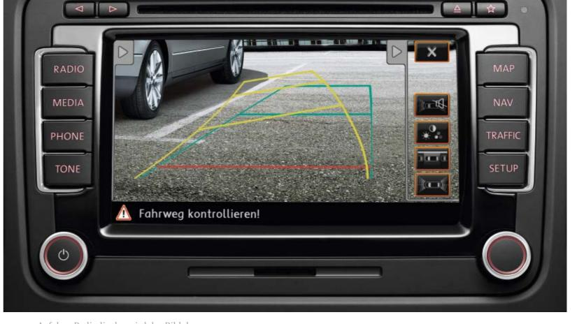
Auf dem Radiodisplay wird das Bild der Rückfahrkamera "Rear Assist"<sup>2)</sup> wiedergegeben. Die freie Sicht hinter das Fahrzeug ermöglicht so einfacheres Einparken.
