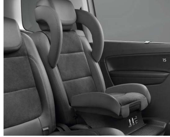
↑ Die zweite Sitzreihe kann wahlweise mit einem oder zwei praktischen integrierten Kindersitzen ausgestattet werden. Für Kinder zwischen 15 und 36 Kilogramm bietet die einfach montierbare Seitenkopfstütze zusätzlichen Schutz für den Kopf und die Halswirbelsäule. Selbstverständlich entsprechen alle Kindersitze von Volkswagen höchsten Sicherheitsstandards. | so
