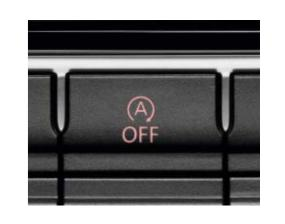
Das Start-Stopp-System<sup>2)</sup> steht für sparsames und schadstoffarmes Fahren. Beim Halten im Stau oder an einer Ampel reicht es, die Kupplung zu lösen und den Gang herauszunehmen bzw. die Bremse zu treten (bei Doppelkupplungsgetriebe DSG), und der Motor schaltet sich aus. | s
