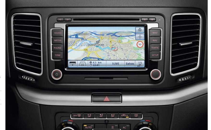
Das Radio-Navigationssystem "RNS 510" mit Sprachbedienung, Picture Navigation, Touchscreen, großem Farbdisplay, DVD-Laufwerk, 30-Gigabyte-Festplatte, SD-Kartenschacht, AUX-IN-Buchse und Verkehrszeichenanzeige ist mit vorinstallierten Europakarten ausgestattet. so
