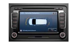
Der ParkPilot mit Sensoren im vorderen und hinteren Stoßfänger warnt Sie beim Einparken mit akustischen Signalen vor Hindernissen: Je näher Sie einem Widerstand kommen, umso schneller wird die Tonfrequenz. |so
