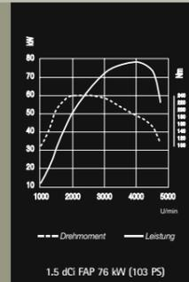
**1.5 dCi FAP 76 kW (103 PS):** Sein maximales Drehmoment von 240 Nm steht bei 2000 U/min an. Auch bei diesem Triebwerk verbindet die Common-Rail-Technologie Leistungskraft und Wirtschaftlichkeit. Seine Sparsamkeit und der deutlich verringerte CO<sub>2</sub>-Ausstoß schonen die Umwelt ebenso wie Ihr Portemonnaie.
