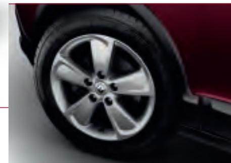
Die Traktionskontrolle ist nur in Kombination mit speziellen 16 Zoll M+S-Reifen funktionsfähig, die extra für den Scénic XMOD entwickelt wurden. Die Lauffläche dieser Reifen bietet höheren Grip und verbessert so die Haftung auf rutschigen, weichen oder sandigen Böden.
