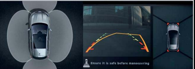
**DIE 4 SEPARATEN WEITWINKELKAMERAS** des Around View Monitors\* zeigen Ihnen auf dem Display eine 360°-Ansicht aus der Vogelperspektive. Mit einer einfachen Berührung können Sie zwischen verschiedenen Ansichten wechseln. Sobald Sie bereit sind, positionieren Sie Ihren QASHQAI einfach innerhalb der auf dem Bildschirm gezeigten Linien und erleben den perfekten Einparkmoment.
