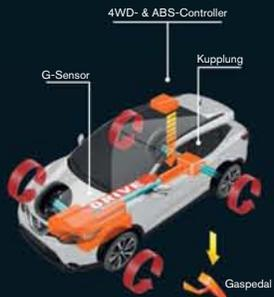
**ALL-MODE 4x4i:** Offroad oder auf der Straße: ALL-MODE 4x4i maximiert die Traktion der Räder, und zwar computer- und sensorgestützt. Das System misst den Radschlupf und verteilt sofort automatisch das nötige Drehmoment, mit bis zu 50 % auf die Hinterräder. Das intelligente System verteilt das Drehmoment auch nach rechts und links, um eine maximale Traktion zu erreichen.
