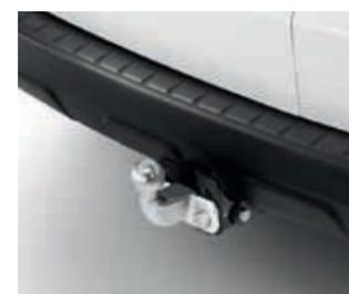
Die **STANDARD-ANHÄNGEKUPPLUNG** ist geeignet für die Kupplung mit Fangmaul oder Zughaken. Für alle gewerblichen Verwendungszwecke. Die **FESTSTEHENDE ANHÄNGEKUPPLUNG** wurde für eine intensive Nutzung entwickelt. Der Kugelkopf dieser elegant geformten Anhängerkupplung kann mithilfe des entsprechenden Werkzeugs abgenommen werden. Eine **abnehmbare Anhängerkupplung** (o. Abb.) ist auch erhältlich.
