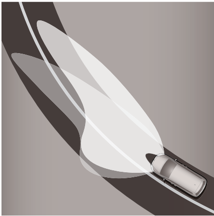
Die Nebelscheinwerfer mit Abbiegelichtfunktion. R St
