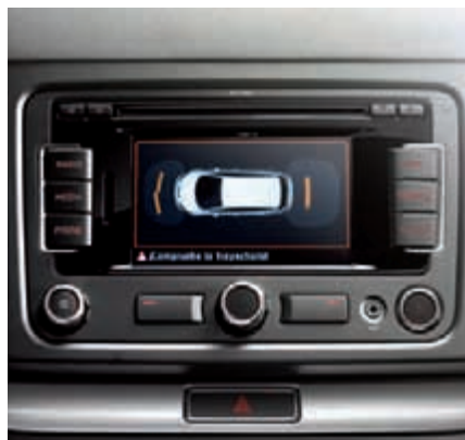
Die Ultraschall-Einparkhilfe zeigt auf dem Display des SEAT Sound-Systems 3.0 oder des SEAT Media Systems die Einparksituation in der unmittelbaren Umgebung des Fahrzeugs an.
