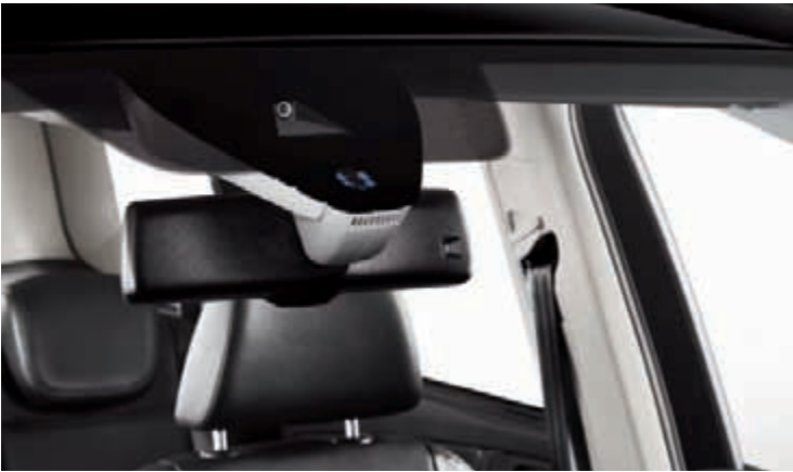
Die Multifunktionskamera mit Spurassistent und Verkehrszeichen-Erkennung.
