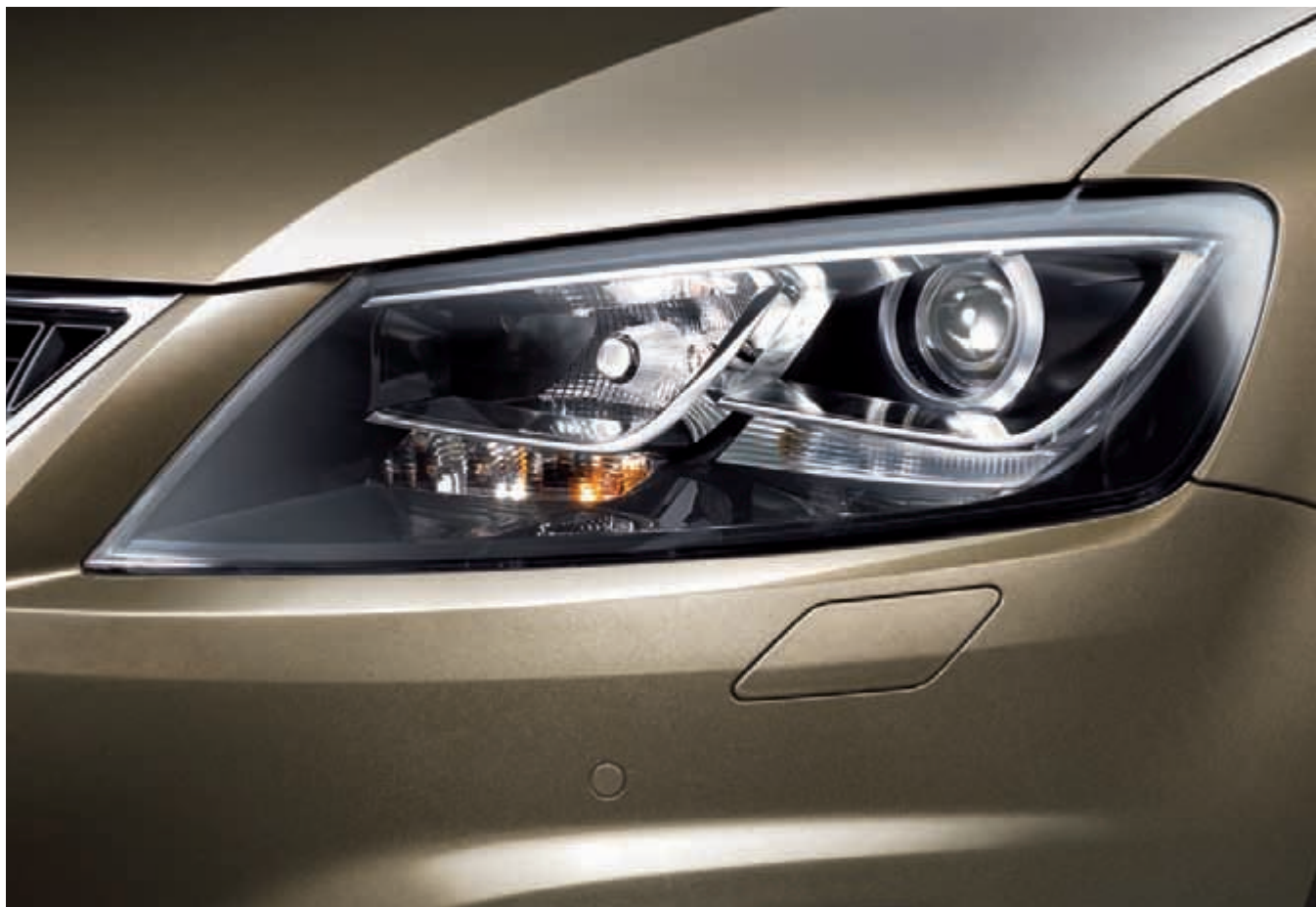
Der Lichtkegel der Bi-Xenon-Scheinwerfer mit dynamischem Kurvenlicht folgt den Lenkbewegungen und leuchtet kurvenreiche Straßen noch besser aus.
