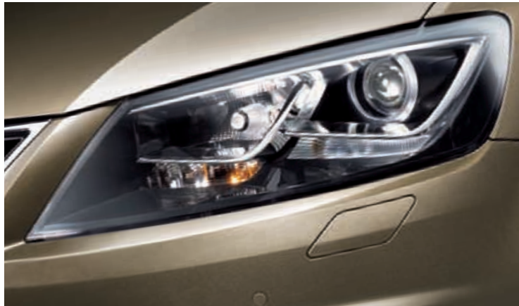
Die Bi-Xenon-Scheinwerfer mit dynamischem Kurvenlicht. St
