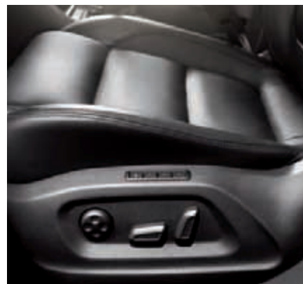
Die elektrisch verstellbaren Vordersitze mit Sitzheizung (Fahrersitz mit Memory-Funktion).
